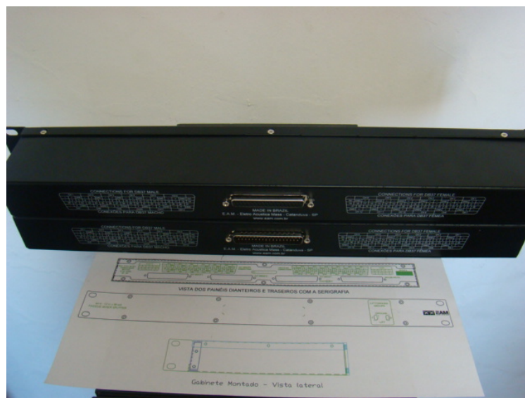
Vista Parcial Traseira dos painéis XLR macho e fêmea com 12 circuitos
